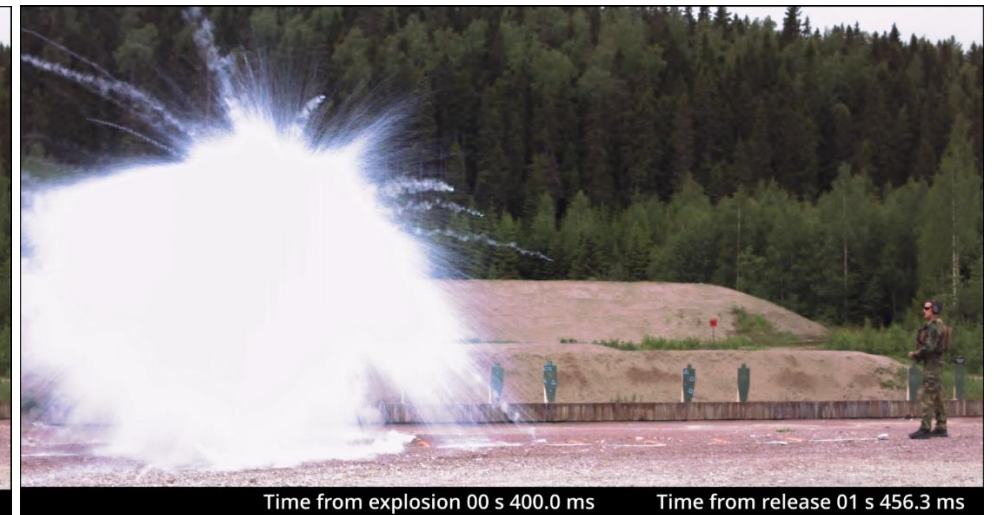
Figur 6: Utstrekningen av TTC-væske henholdsvis 0,1, 0,2, 0,3, og 0,4 sekunder etter at bøssingen har bristet. Foto: SHK. Tidsstempel: FFI
