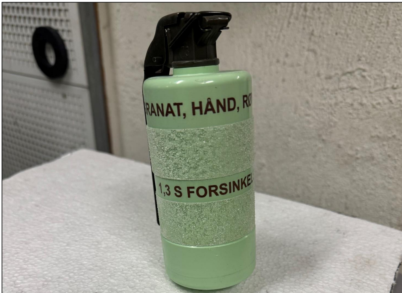
Figur 8: Granatlegemet og tennmekanismen til NM239. Foto: SHK
