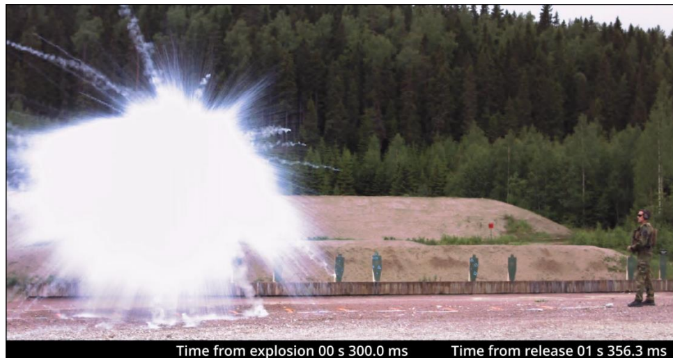
Figur 6: Utstrekningen av TTC-væske henholdsvis 0,1, 0,2, 0,3, og 0,4 sekunder etter at bøssingen har bristet. Foto: SHK. Tidsstempel: FFI
