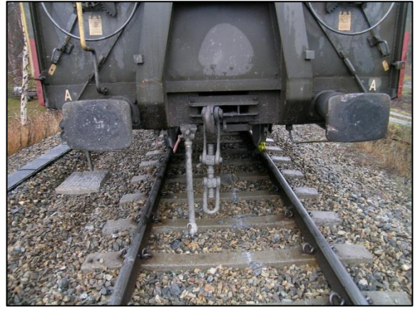
Figur 3: Kobbel og kran m/slange på andre vogn i toget. Foto: Jernbaneverket
