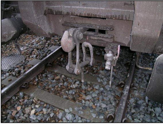
Figur 2: Bakre kobbel og kranhus på første vogn. Slangen med koblingshode ble funnet etter planovergangen som ble ødelagt. Foto: Jernbaneverket
