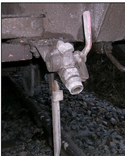
Figur 8: Kranen som ble slått til stengt stilling. Foto: Jernbaneverket
