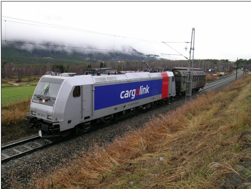
Figur 4: Lokomotivet Traxx BR 185 og avsporet godsvoggen Hbbillns. I bakkant skimtes bakre del av toget. Foto: Jernbaneverket
