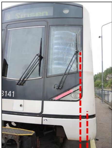
Figur 6: Skader i front etter borstenger. Foto: SHT
