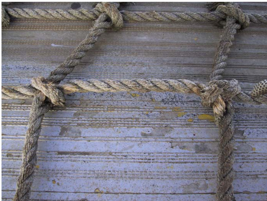
Fig. 2. Taunett med knuter. Taunettet ligger med et par cm klaring til dekket og nettet har vært strukket i knutene.
