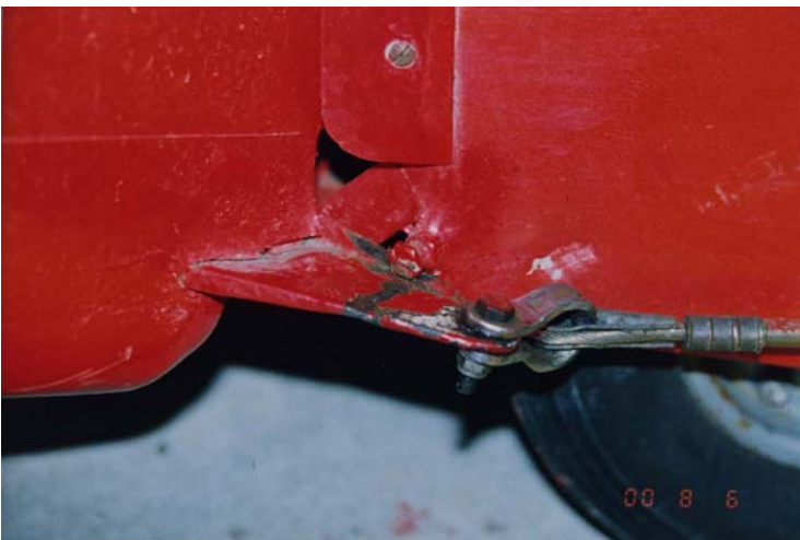
Fig. 2 Endestopp for sideror i låst posisjon mot skroget.
