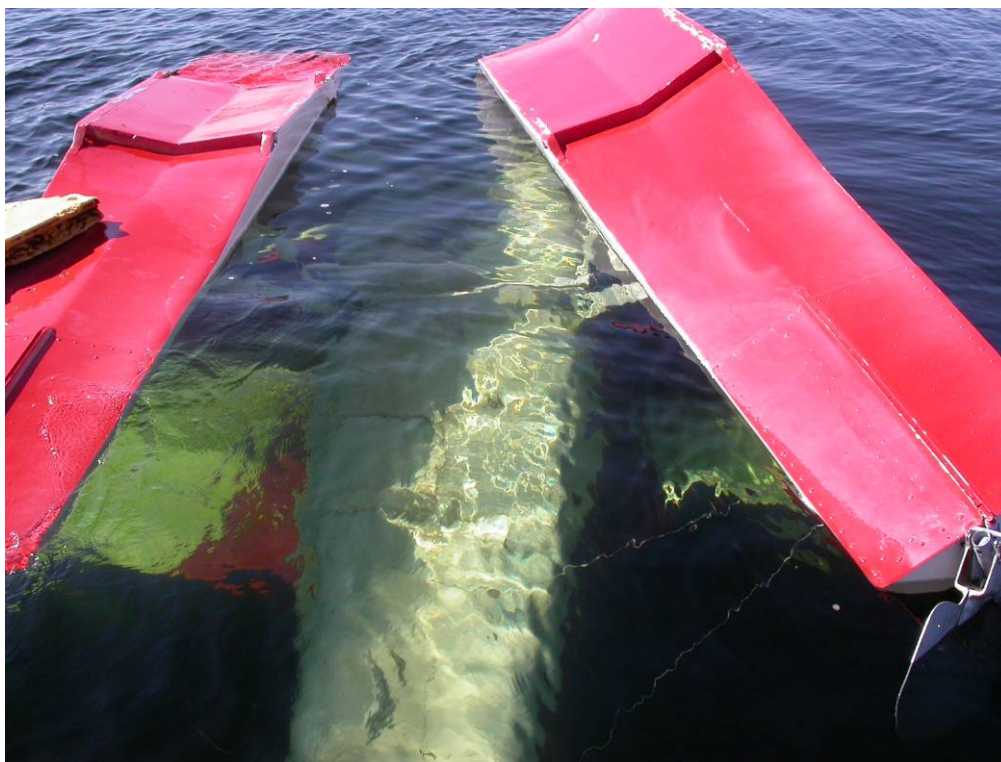
Fig. 4. Flottørene, type Fibrefloats 2400, etter havariet
