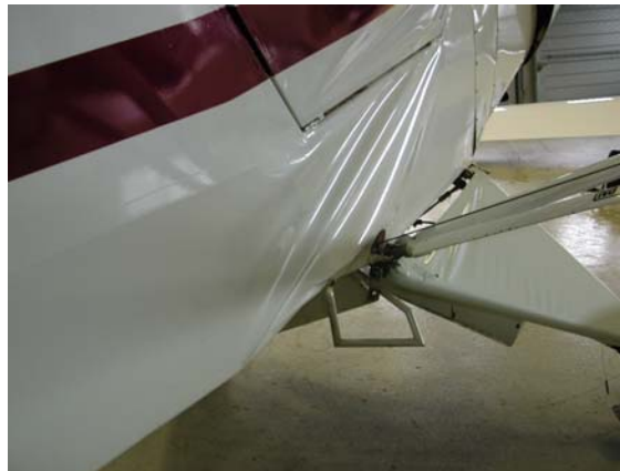
Figur 2: Skade på understell, vingestag og skrog.
