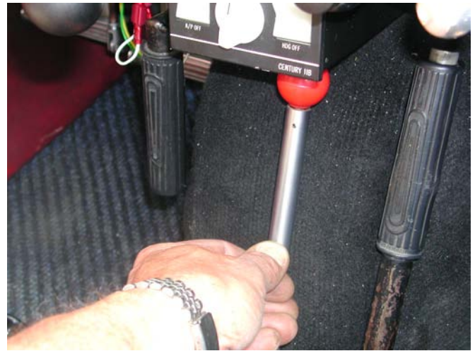
"Emergency handle" i konflikt med autopilotpanelet (venstre), og i låst posisjon (høyre).
