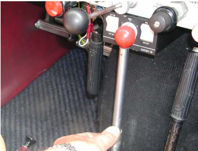
"Emergency handle" i konflikt med autopilotpanelet (venstre), og i låst posisjon (høyre).
