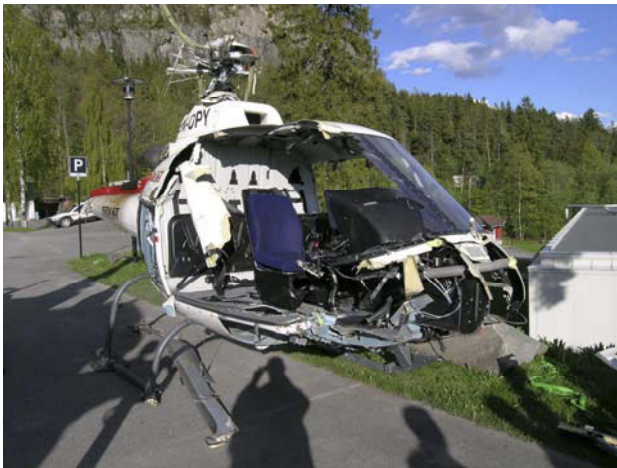
Figur 7: Skade på kabinens høyre side.
