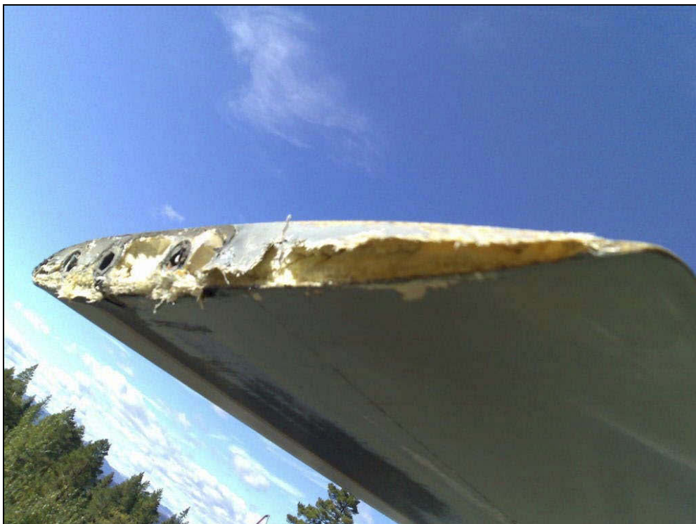
Figur 2: Skader på hovedrotorblad nr. 1. Det var tilsvarende skader på blad nr. 2 og 3.
