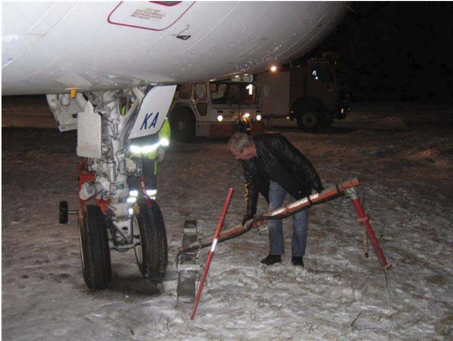
Figur 1: Skadet Localizer Monitoring antenne med betongfundament.
