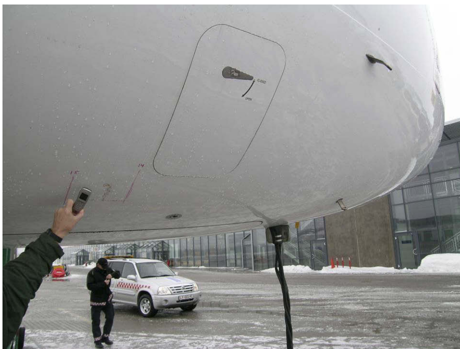
Figur 9: Liten bulk i skrogsiden mellom stasjon 14 og 15.
