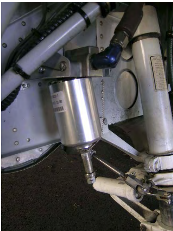
Figur 3: Kopp (bowl) som hadde løsnet fra "top assy".
