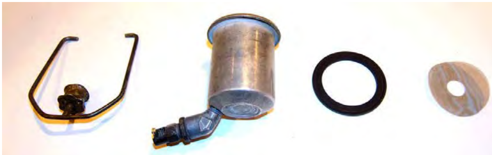
Figur 4: Deler av "Gascolator Assy": Festebøyle, kopp med "drain nipple", pakning, filter.
