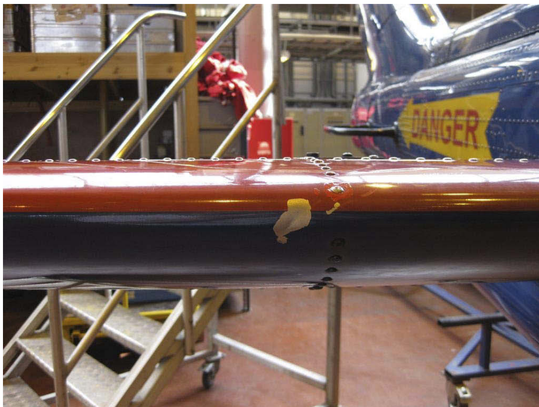
Figur 2: Skader i forkant av høyre horisontal stabilisator. (Foto: CHC Norway)
