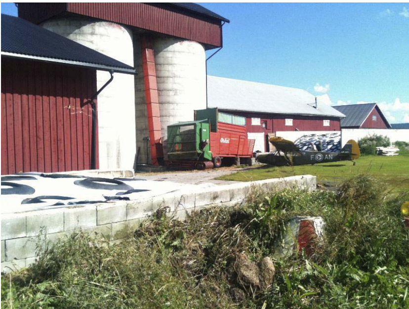
Figur 2: LN-ACL ligger på buken med avrevet understell etter å ha truffet betongkanten sentralt i bildet. Merk synlige spor etter anslag fra venstre ving på hjørnet av driftsbygningen til venstre i bildet. Rød og hvitmalt banekantmarkør og banelys er synlig i gresset til høyre i bildet, foran betongkanten.
