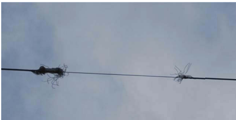
Figur 2: Nærbilde av skadet ledning. (Foto: Hasvik Lensmannskontor)
