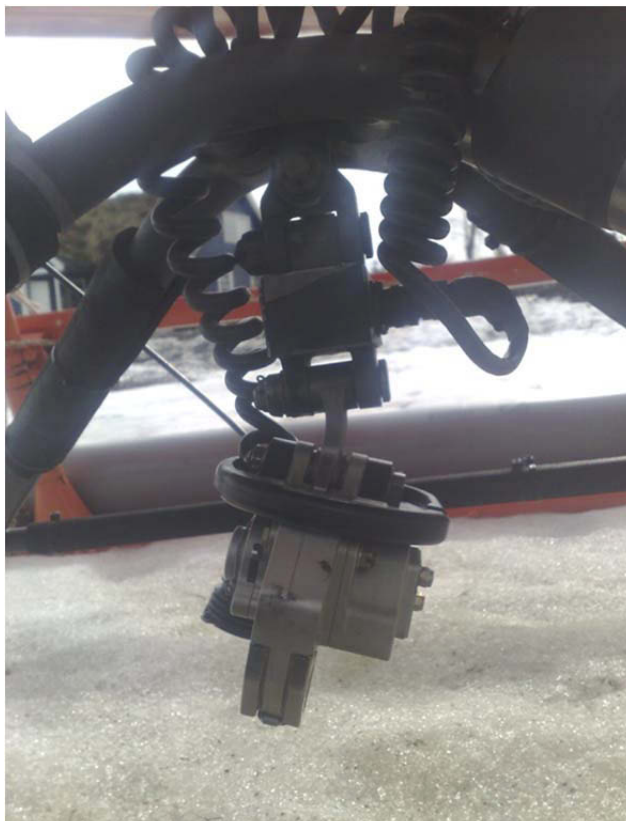
Figur 3: Skadet lastekrok med innfesting i "cargo swing". (Foto: NORD helikopter)
