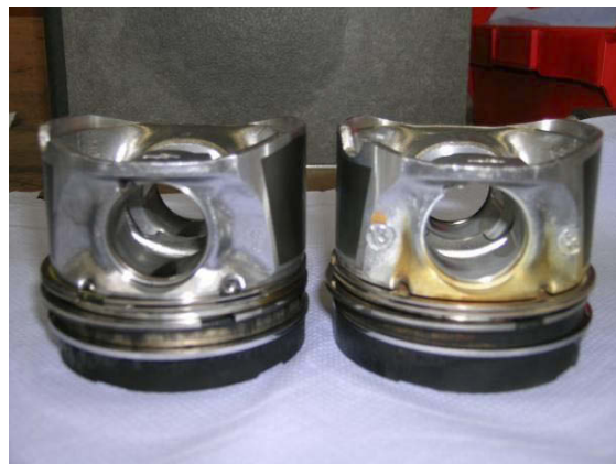
Figur 17: Fargeforskjell. Stempel som har gått 1000 timer (referansestempel) til venstre og stempel nr. 1 fra LN-NEX til høyre.
