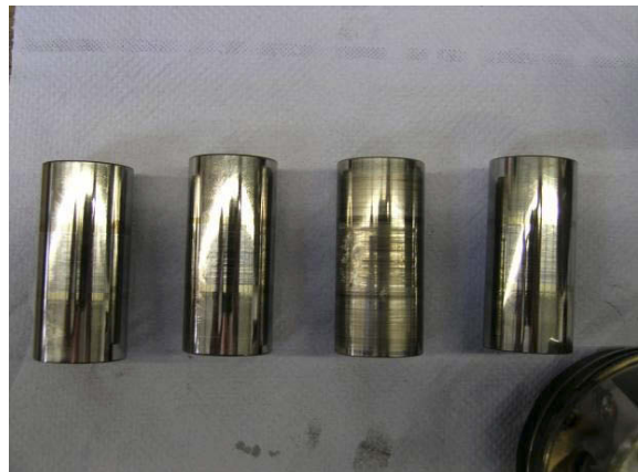
Figur 15: Fargene på kryssboltene indikerer varmgang.
