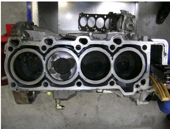
Figur 8: Bilde tatt ned i sylindrene. Stempelet i sylinder nr. 3 (nr. 2 fra venstre) har merker etter sammenstøt med topplokket.
