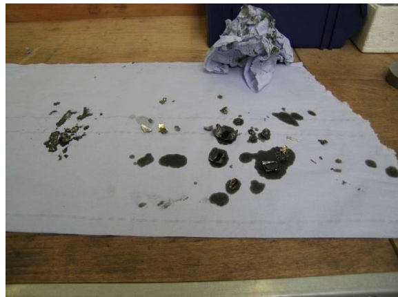
Figur 13: Små og store metallgjenstander funnet i bunnpotten og oljefilterenheten.
