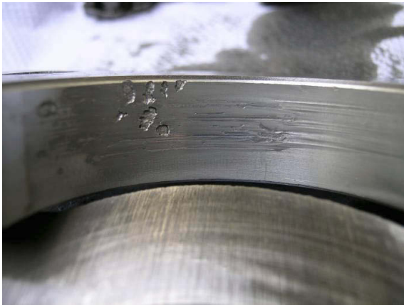
Figur 10: Skader i veivaxselens bærelager nr. 1.
