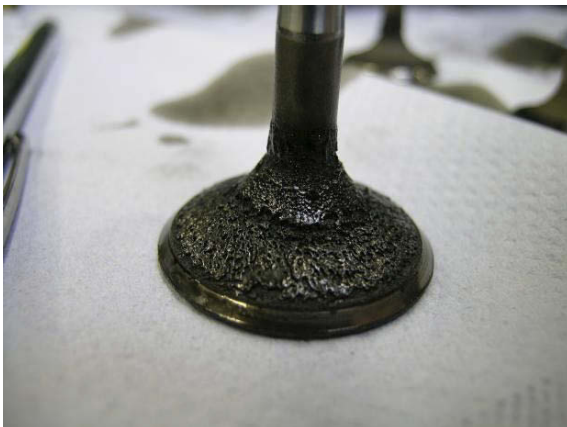
Figur 14: Fastbrent sot på inntaksventil.
