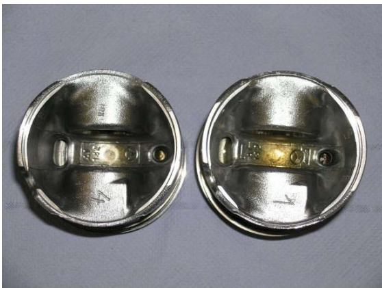
Figur 16: Fargeforskjell. Stempel som har gått 1000 timer (referansestempel) til venstre og stempel nr. 1 fra LN-NEX til høyre.
