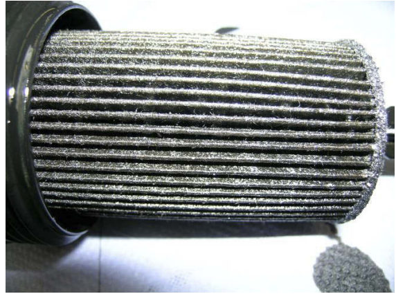
Figur 7: Motoroljefilteret forurensset av metallpartikler.
