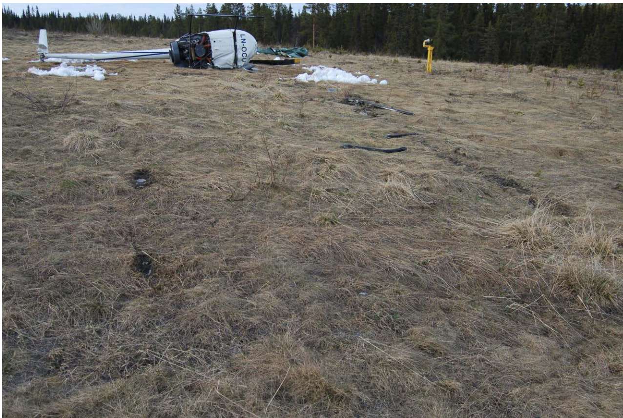
Figur 2: Havaristedet sett i retningen helikopteret fløy da det traff bakken. I forgrunnen til høyre vises merkene etter venstre understellsmeie, og i forgrunnen til venstre vises merkene der hovedrotorbladene tok i bakken. Terskelen på bane 33 ligger til venstre utenfor bildet.
