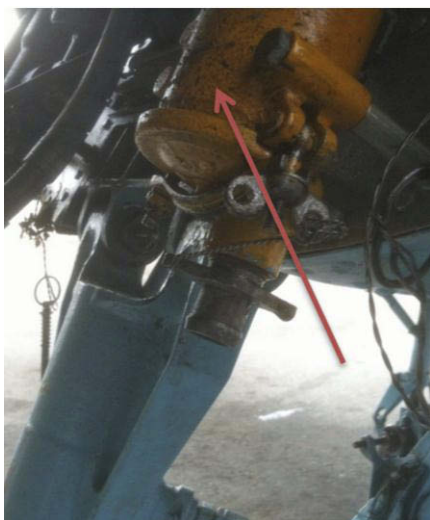
Figur 2: "Gascolator" der det ble påvist drivstofflekkasje.
