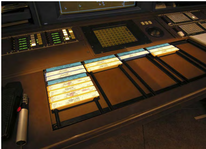
Figur 3: Utforming av trafikkbordet i sektor Skagerrak, med fem seksjoner, og bruk av gule og blå trafikkstrippholdere (Merk: trafikkstrippene er ikke fra den faktiske hendelsen).
