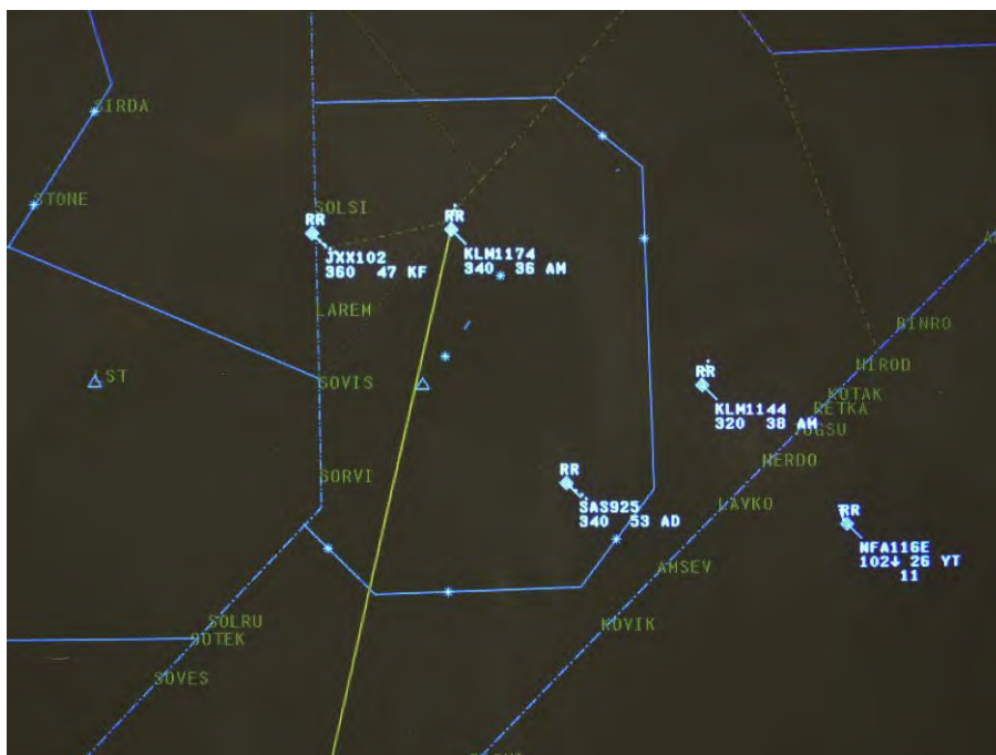
Figur 4: Utsnitt av radarbilde ca. kl. 1340. KLM1174 og SAS925 flyr på kryssende kurs i FL340. Flygeleder hadde lagt opp en avstand og retningslinje (gul linje) fra KLM1174 i retning mot "ARTIP". JXX102 flyr i FL360, og er på vei ut av sektor Skagerrak i vestlig retning. KLM1144 flyr i FL320, og er på vei ut av sektoren i SSW retning.
