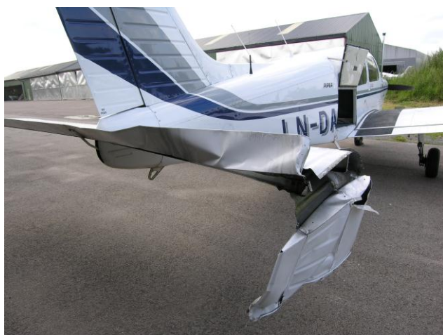
Figur 2: Betydelige skader på LN-DAX.
