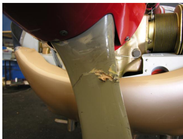
Figur 3: Propellbladskader på LN-TVI.
