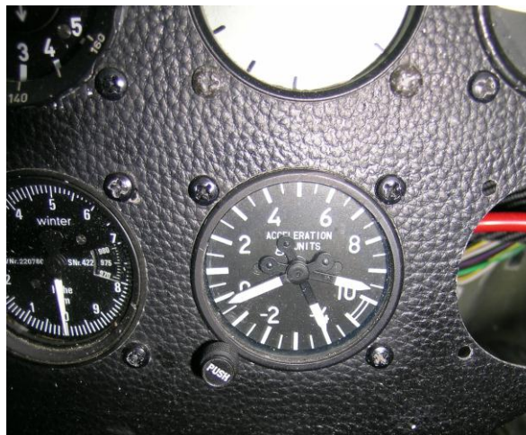
Figur 3: Flyets g-måler. Pilen lengst til høyre indikerer litt over +9,5 g.
