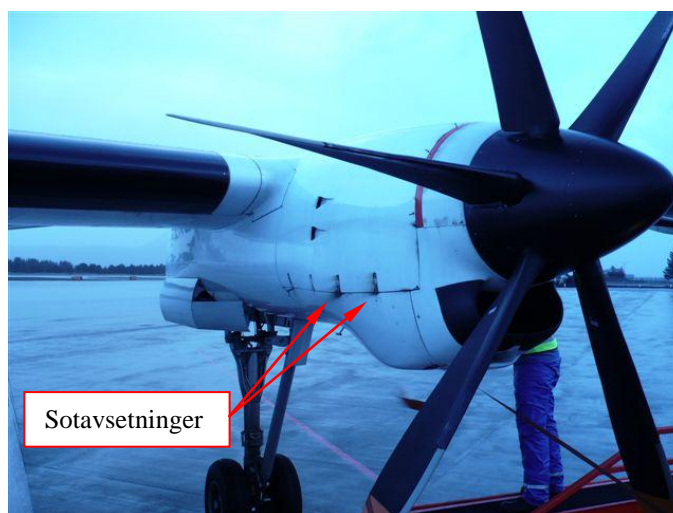
Figur 1: LN-RNG etter nødlandingen på Vigra. Venstre motor har utvendige sotavsetninger.
