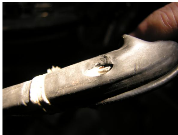
Figur 3: Den elektriske ledningsbunten med avskavet isolasjon.
