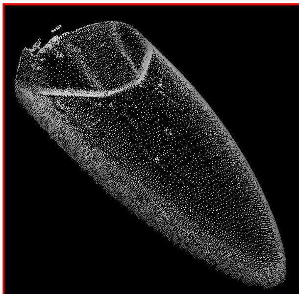
Figur 11-3 Punktsky generert fra et skann (PolyWorks, 2009)
