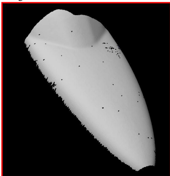
Figur 11-20 Eksempel på områder funksjonen "fill holes" ble brukt (PolyWorks, 2009)
