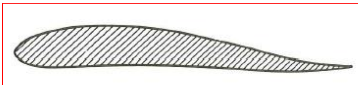
Figur 8-1 Mange av dagens vingeprofiler har konkav krumning på undersiden (A C Kermode, 1987)
