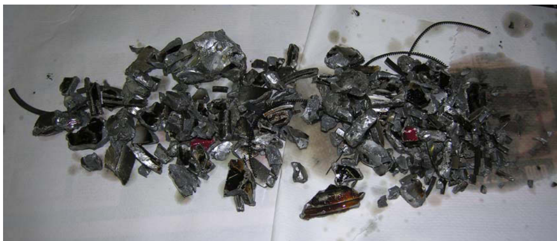
Figur 3: Biter av stampelet og stempelringene fra sylinder nummer 2 funnet i motorens bunnpanne.
