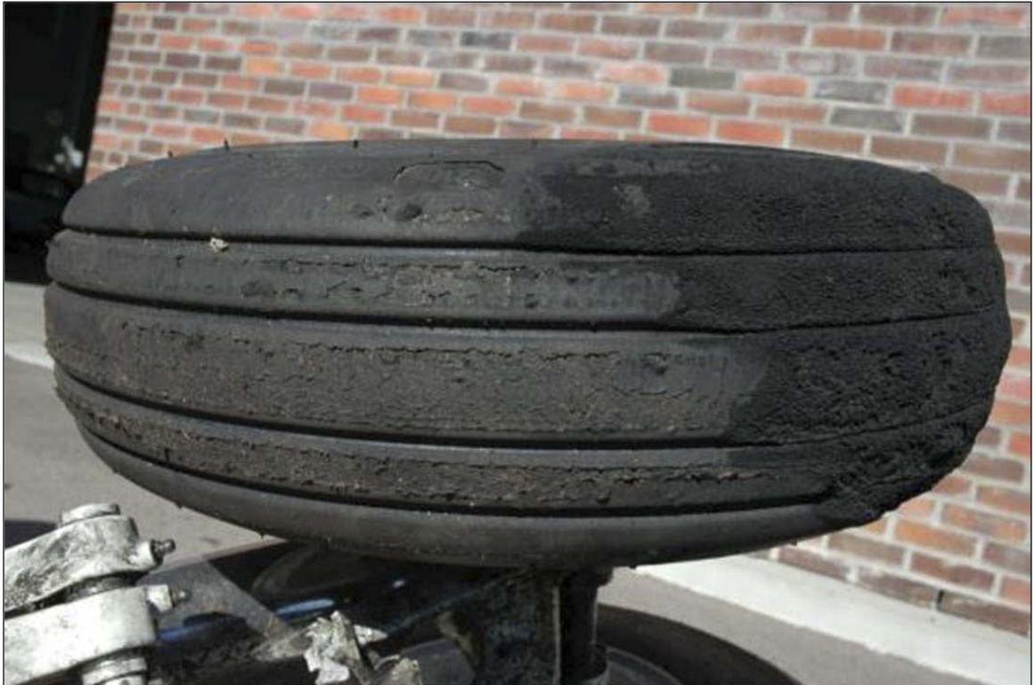
Figur 25: Høyre nesehjul. Tydelige slitasjemerker til venstre og varmeskade til høyre.
