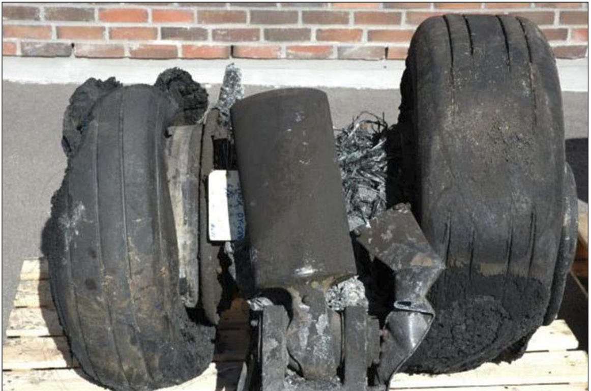
Figur 26: Hjulene på venstre hovedunderstell. Venstre hjul er til høyre på bildet.
