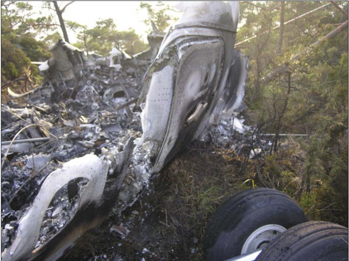
Figur 33: Viser cockpit og blokkering av fremre høyre nødutgang. Dørhåndtaket er skjøvet ut (delvis åpnet). I forgrunnen til høyre ligger nesehjulene.
