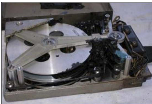
Figur 16: Varmeskadet lagringsenhet i ferdsriver.
