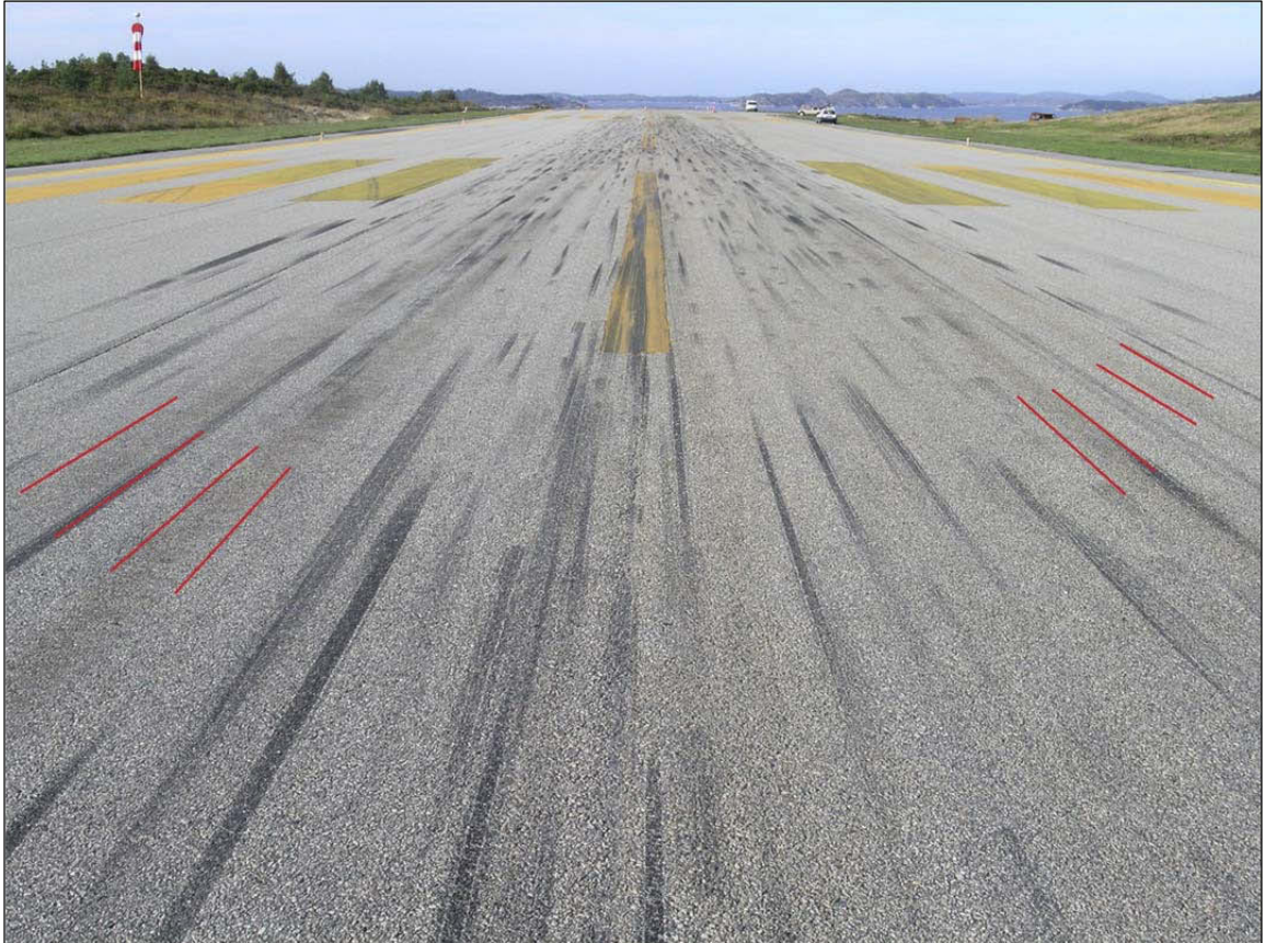
Figur 20: Sporene etter OY-CRG på rullebanen. Hjelpelinjer i rødt viser hvor hovedhjulene gikk.
