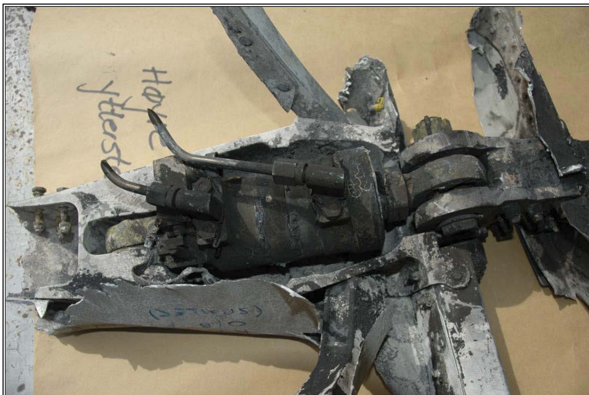
Figur 34: Viser en av de seks liftspoileraktuatorene.
