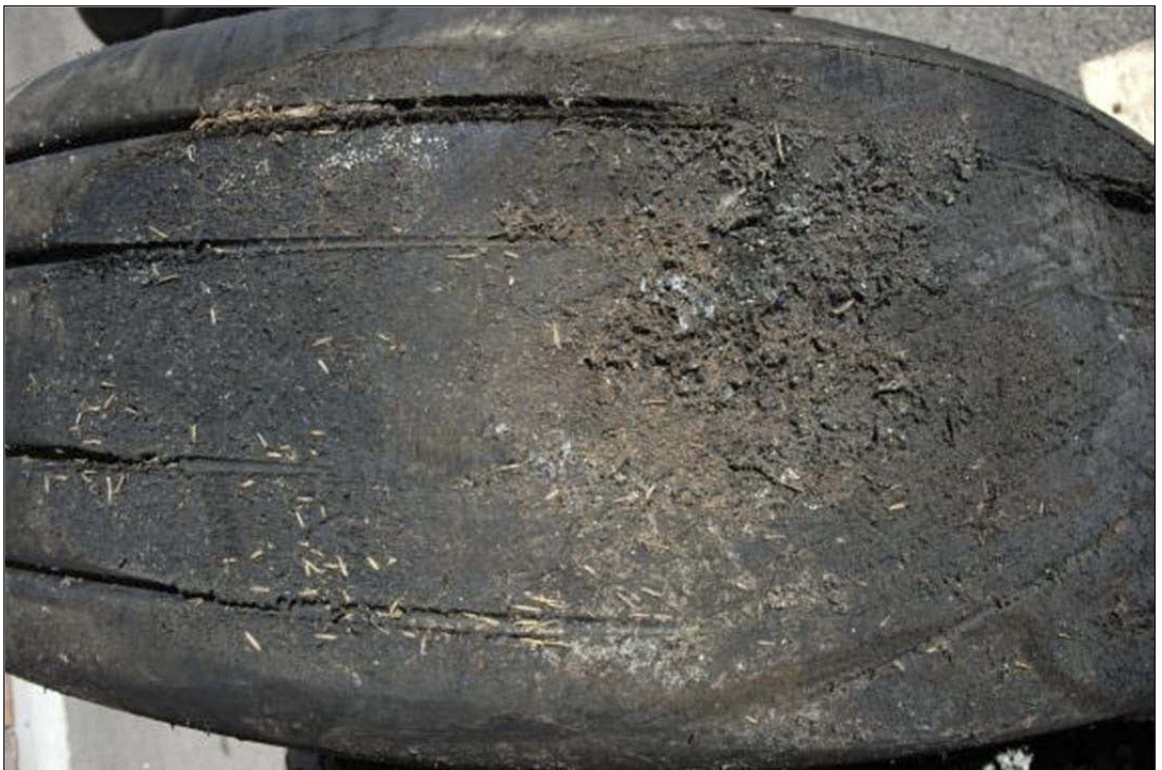
Figur 27: Slitasjemerker på venstre dekk på venstre hovedunderstell. Dekket har i en periode beveget seg fra venstre mot høyre med en vinkel på 27^\circ i forhold til asfalten. "Kladder" med dekomponert gummi til høyre på bildet.
