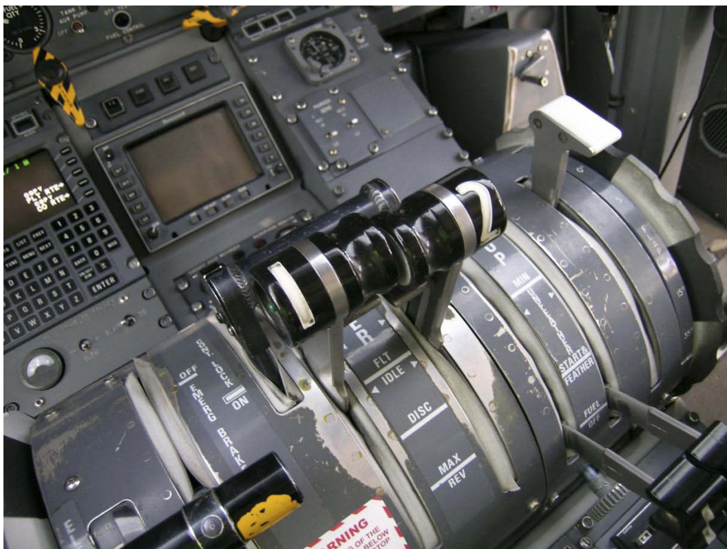
Figur 2: Power Levers merket 1 og 2 sentralt i bilde og Condition Levers nede i bildets høyre hjørne (Fuel Off).
