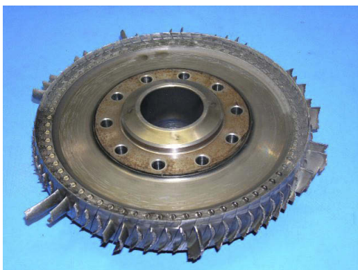
Figur 8: Skader på kraftturbinens andre trinn.
