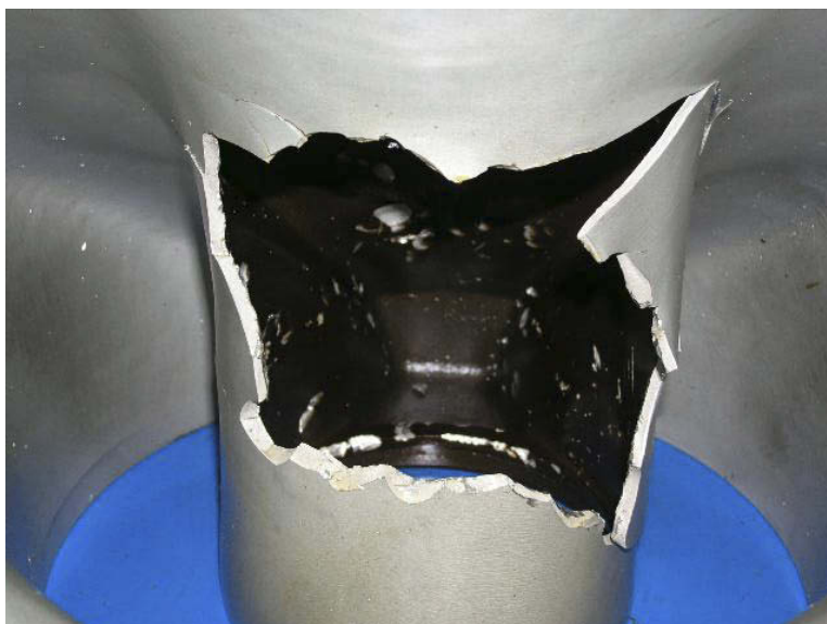
Figur 7: Skader i luftinntaket på høyre motor som oppsto da akselen mellom motoren og gearboksen røk.
