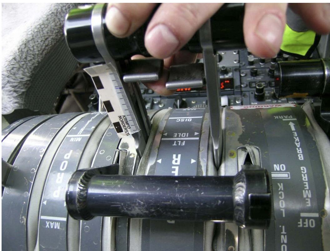
Figur 3: Bilde av sperrehendlene som må løftes, og som forhindrer at Power Levers kan dras direkte forbi FLT IDLE og inn i Ground Idle. Hendelen for høyre motor (venstre på bilde) er løftet ut av inngrep. Bildet er tatt bakover fra instrumentpanelet. Den sorte hendelen i forgrunnen av bildet er Flight Control Lock. Lengdemålet er påført av SHT.
