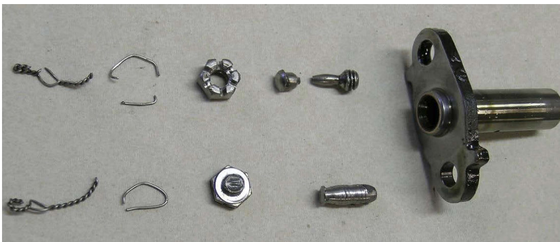
Figur 4: Delene som holdt venstre løpehjul (Gear, Crankshaft idler).
