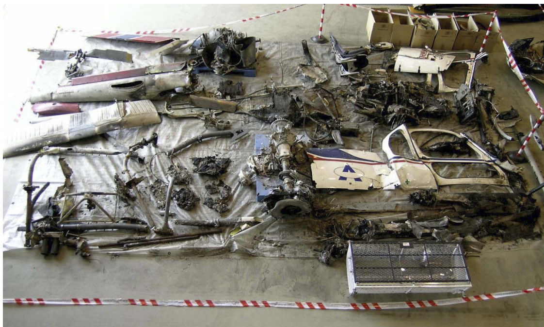
Figur 9: Forenklet rekonstruksjon av vraket i havarikommisjonens hangar
