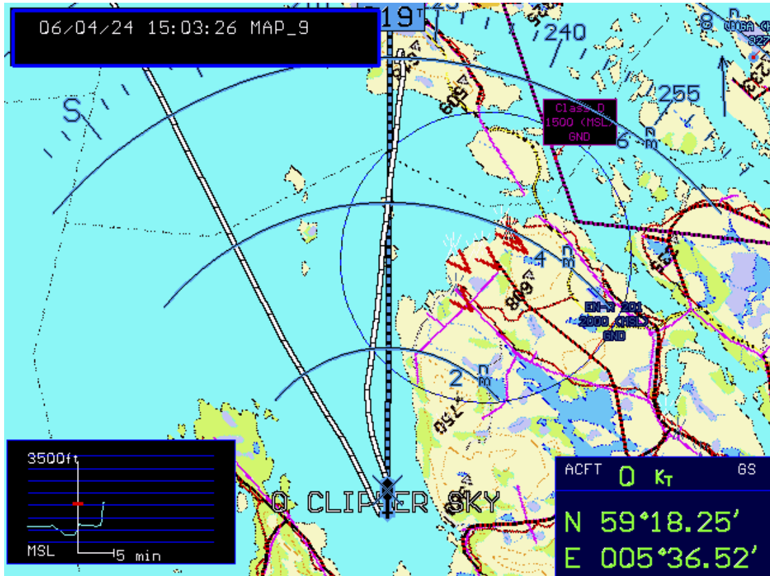
Figur 8: Avspilling av fløyet rute med hvit stiplet linje (innkommende rute til venstre og havaristedet i øvre billedkant). Det direkte trekket mellom “Clipper Sky” og “Berge Danuta” er markert med mørk blå stiplet linje. Luftfartshindringer på Kårstø er markert som røde høydesymboler (vinkler). Informasjon om helikopterets flygehøyde de siste 10 minuttene er gjengitt med blå strek i nedre venstre hjørne.
