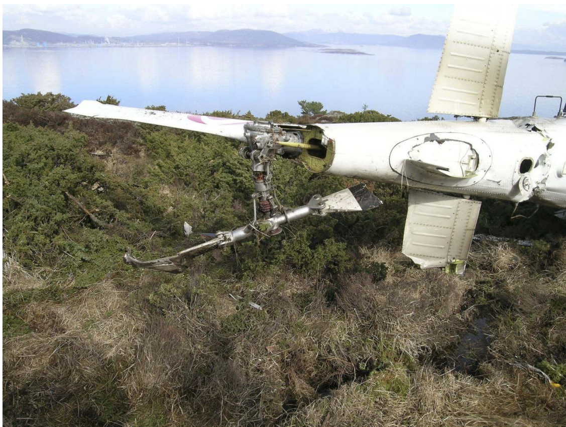
Figur 6: Halen på helikopteret. Halerotorgearboksen sitter fast selv om halerotoren henger delvis løs fordi akslingen er knekt. Halekonen og bøylen som beskytter halerotoren er slått av. Til høyre på bildet er halebommen nærmest delt i to. I bakgrunnen til venstre sees Kårstø. I bakgrunnen til høyre for midten i bildet sees Herviksfjorden hvor "Clipper Sky" lå.
