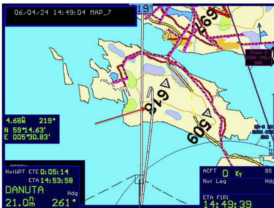
Figur 2: Øya Austre Bokn gjengitt på helikopterets elektroniske kart (Euronav). Den rette linjen til "Berge Danuta" til venstre (219°) og trekket helikopteret fløy til høyre. Det viser at helikopteret dreiet nær 180° til venstre like før havaridet. Havaristedet angitt med rød pil (se også Figur 8).
