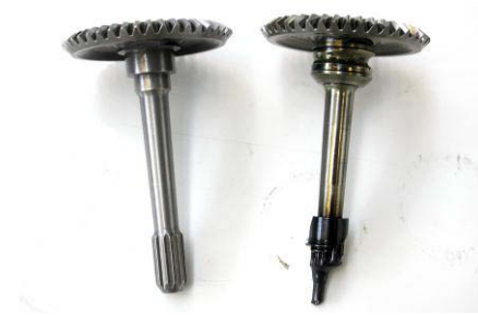
Figur 5: Til høyre er accessory bevel gear med nedsmeltet spline ende og bruddfragment fra tilhørende "hun" spline.
