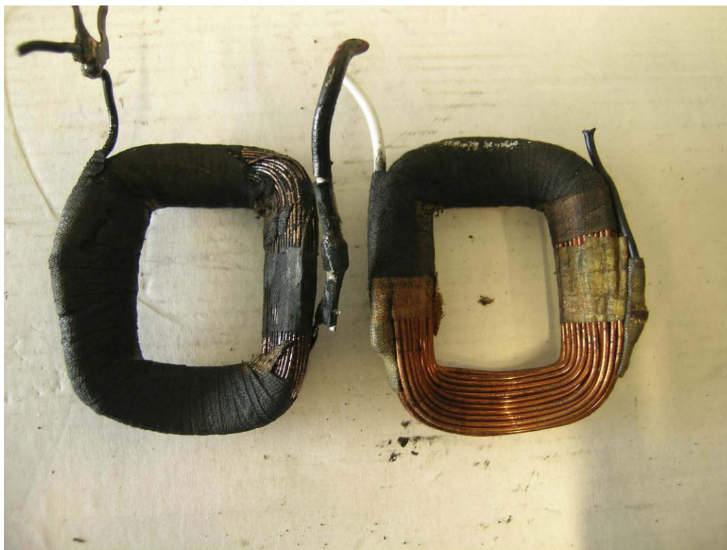
Figur 4: Statorviklingen til venstre er brent.
