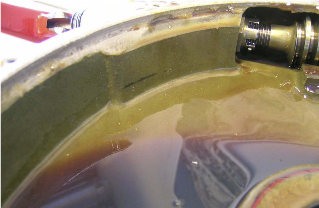
Figur 2: Bronsepartikler i gearoljen. Deler av snekkeskruen vises i øvre høyre hjørne.
