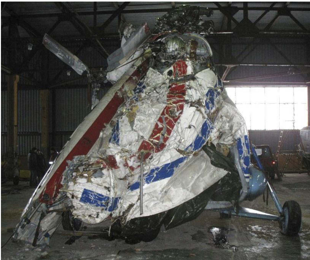
Figur 10: Skadene i overgangen mellom skrog og halebom. Halebommen og halerotoren til venstre på bildet.
