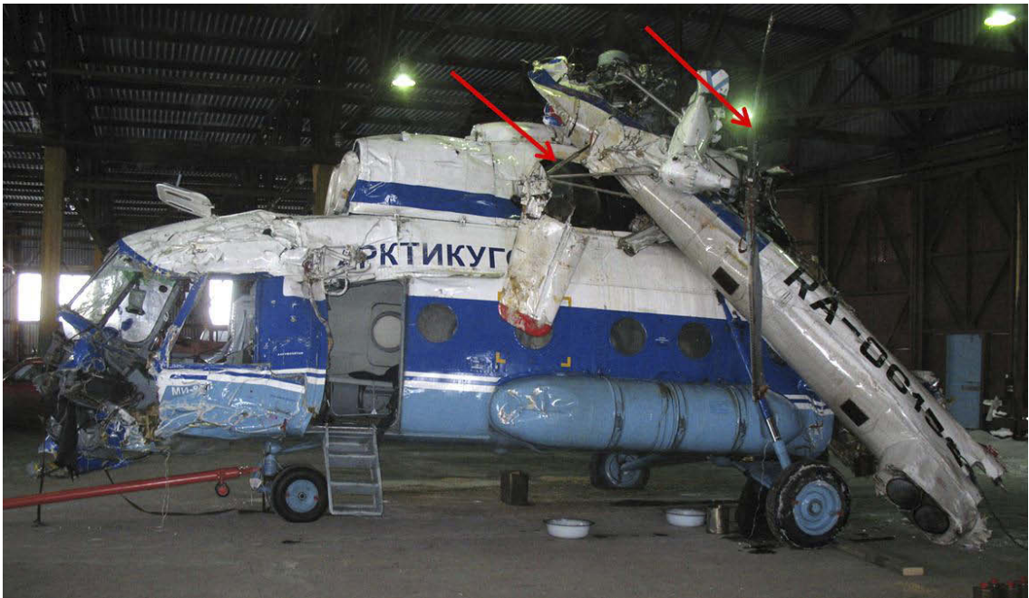
Figur 9: Skadene på helikopterets venstre side. Halerotoren og den uskadede støtten bakerst på halebommen er merket med røde piler.
