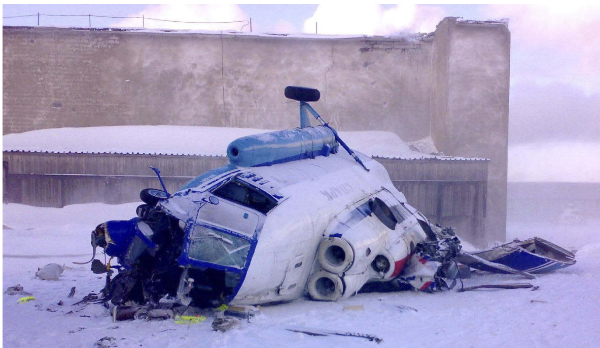
Figur 7: Bilde av helikopteret tatt kort tid etter ulykken skjedde. Legg merke til de fire markerte slagmerkene etter hovedrotoren på hangarveggen.
