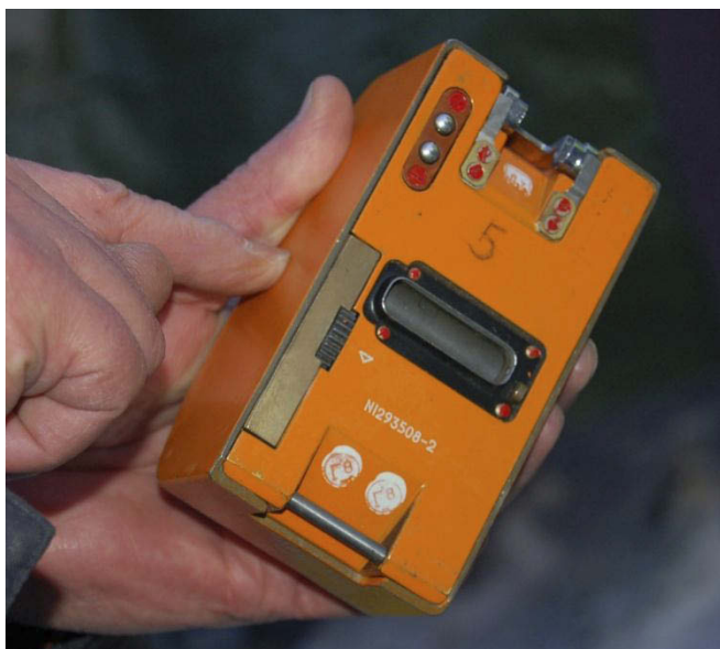
Figur 4: Lagringsenheten til ferdskriveren (kassett inneholdende fotografisk film).
