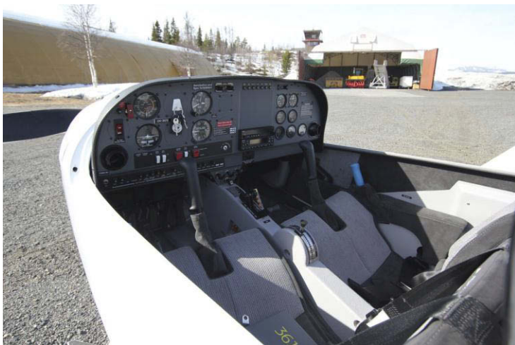
Figur 1: Cockpit i LN-GFG. Trottle (gasshåndtaket) er plassert midt mellom setene og kan opereres fra begge posisjoner. Stikke er plassert i front av begge seter. Luftbremshåndtak er plassert til venstre for venstre sete og til høyre for høyre sete (blått håndtak). (Foto: Fartøysjef LN-GFG)
