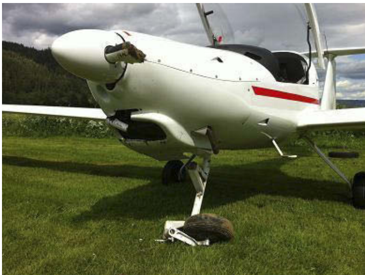
Figur 2: Bildet viser LN-GFG etter landingsulykken, som medførte brukket nesehjulslegg, skadet propell og oppskrapet underside. (Foto: Fartøysjef LN-GFG)
