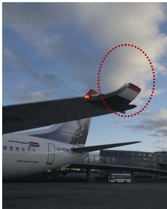
Figur 4: NAX765, LN-NON. Winglet på venstre vinge ble revet av. (Foto: OSL)
