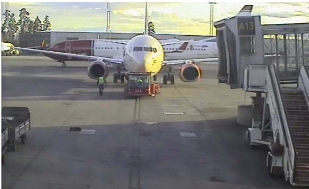
Figur 1: Kl. 18:34:35. Norwegian-flyets venstre vinglet traff først SAS-flyets venstre høyderor, og deretter høyre høyderor. (Videoklipp: Oslo lufthavn AS, - kamera på gate 13)
