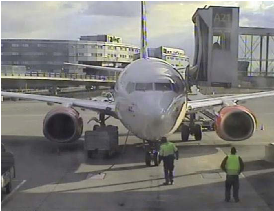
Figur 1: KI. 17:45:30 Videoklippet viser flybroa, etter at den var hevet til maksimal høyde, og før den ble trukket tilbake. Brokjøreren kan skimtes gjennom vinduet på flybroa. Evakueringskليا, som er montert i en boks i flydøra, er bent inn i flybroa. (Videoklipp: Oslo lufthavn AS)
