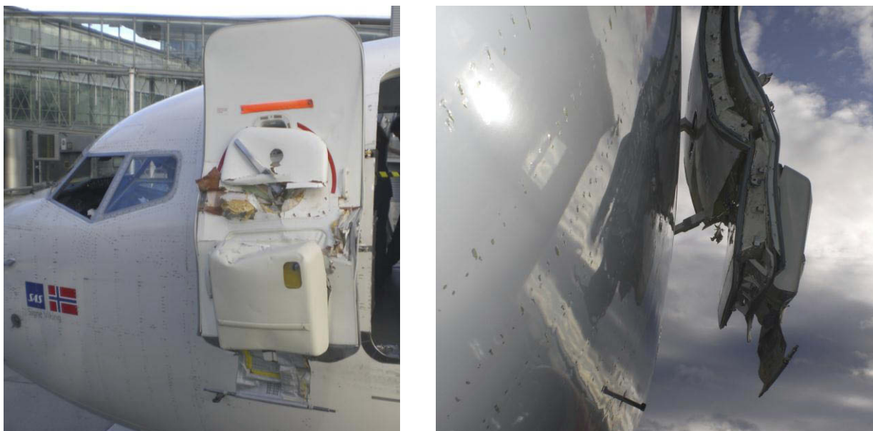
Figur 2: Skadene på flydøra. Den hvite boksen nederst på flydøra inneholder evakueringskليا og gassbeholder. Utløsningsmekanismen med metallstang (girt bar) henger løs slik den gjorde under hendelsen. (Foto: SAS)
