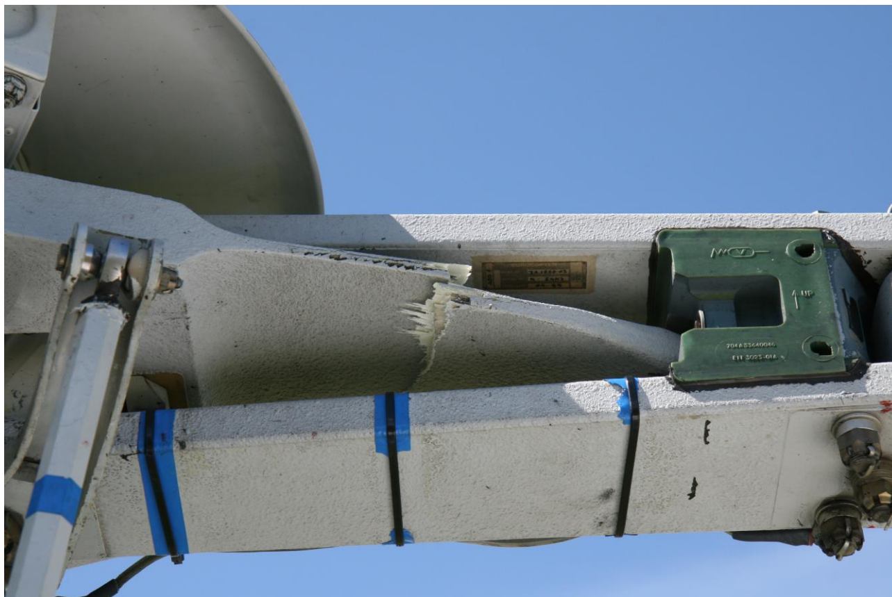
Figur 1: Rotorhode med brudd i Starflex.
