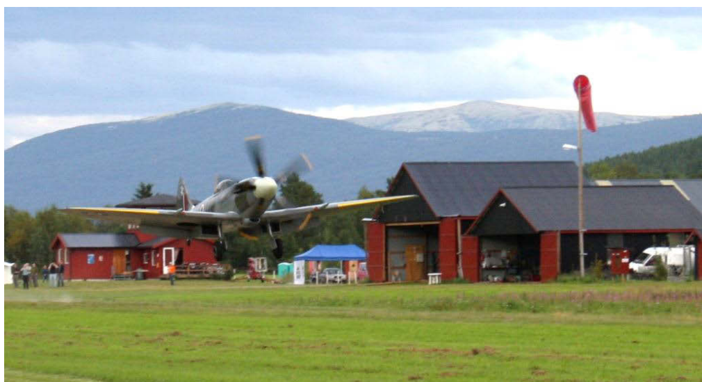
Figur 3: SE-BIN ca. 5 m over rullebanen. Vindpølsen i bakgrunnen indikerer at det blåste anslagsvis 5 kt fra ca. 255°. Til venstre på bildet sees også støv som virvles opp av flyet. Foto: Privat.
