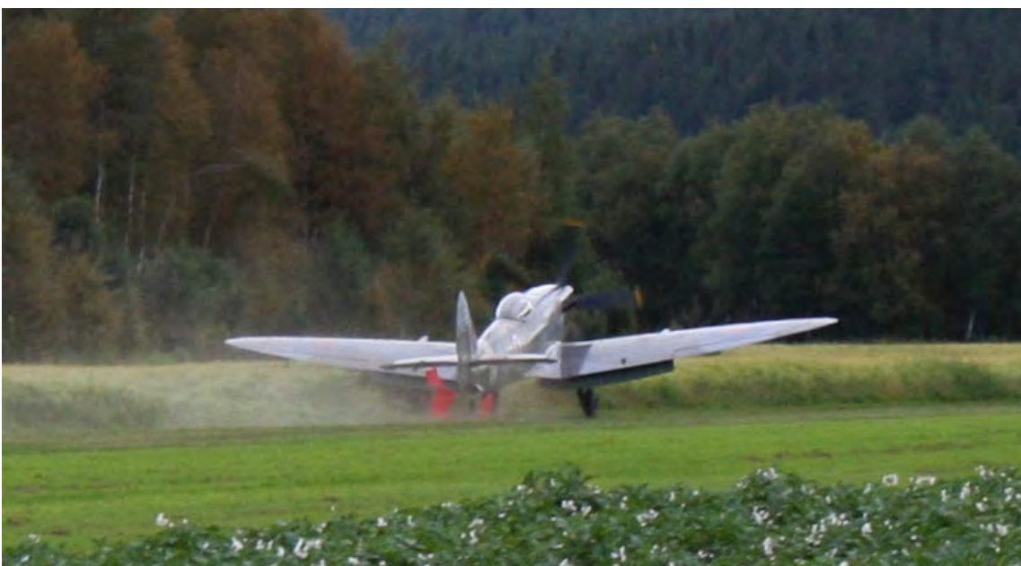
Figur 2: SE-BIN har nettopp kjørt over en banemarkør og er i ferd med å kjøre inn i åkeren. Halehjulet er ikke i kontakt med rullebanen. Høyderoret har "nose up" utslag mens balanserorene og sideroret er i nøytralt. Foto: Privat.
