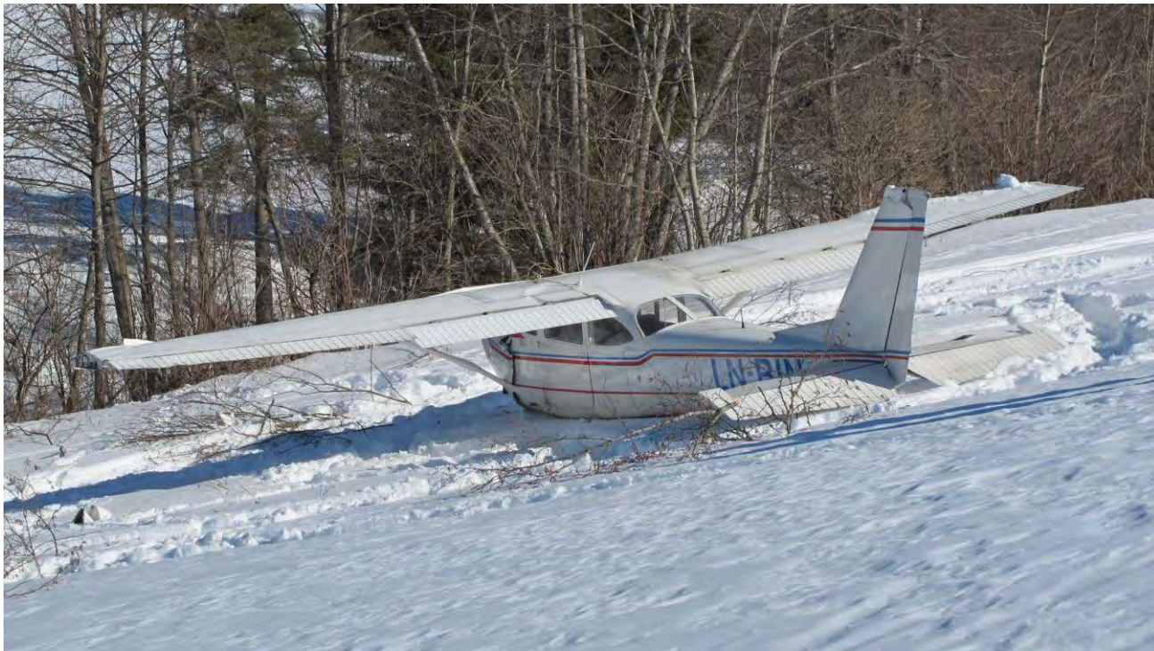
Figur 1: Bildet viser LN-BIN etter nødlandingen som medførte store strukturelle skader på flyet. Foto: Politiet
