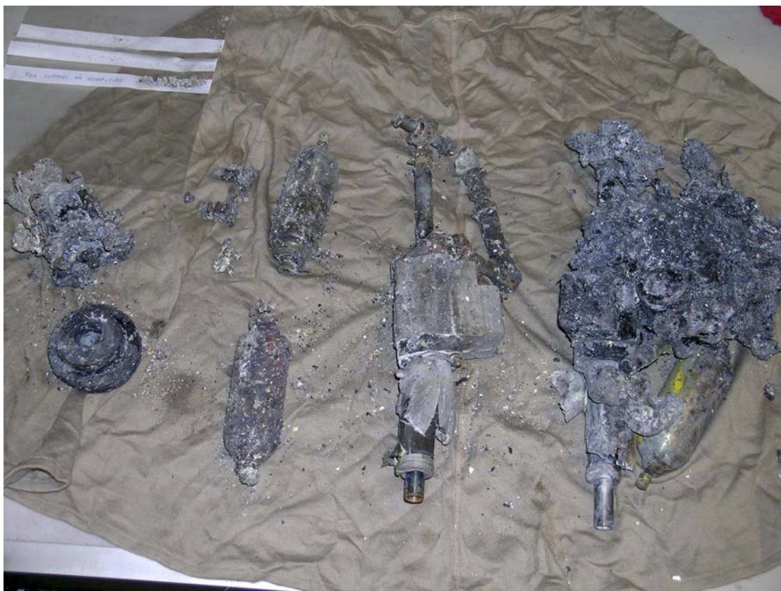
Figur 5: Fra venstre mot høyre: hydraulikkpumpe med drivhjul, to akkumulatører, servo uten akkumulatør og komplett servo med akkumulatør. Foto: SHT
