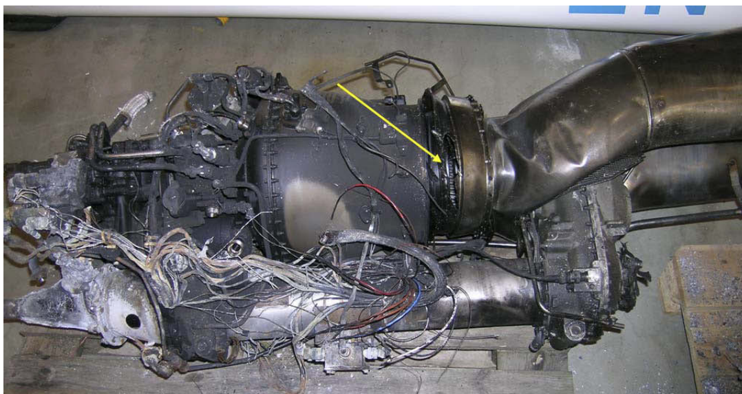
Figur 6: Motoren med sotmerker. Gul pil peker på revnen hvor turbinbladene gikk ut. Beskyttelsesringen er rett til høyre for revnen. Foto: SHT
