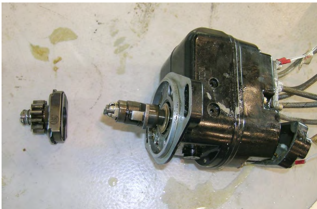
Figur 19: Motorens venstre magnet og det tilhørende drivhjul som løsnet og fulgte med ut fra motoren ved demontering. Foto: SHT
