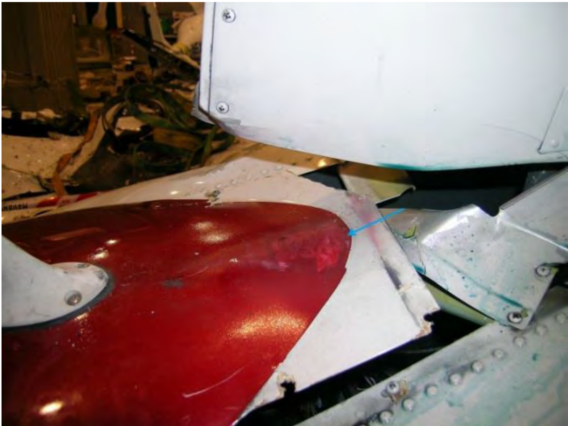
Figur 12: Blå pil peker mot merker på kabintaket i bakkant av rotormasten. Foto: SHT
