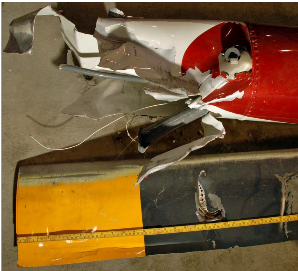
Figur 17: Oversiden av helikopterets hale og undersiden av hovedrotorblad B lagt ved siden av hverandre i tilnærmet riktig relativ posisjon. Bladet har et merke som tyder på at det har truffet antikollisjonslyset. Foto: SHT
