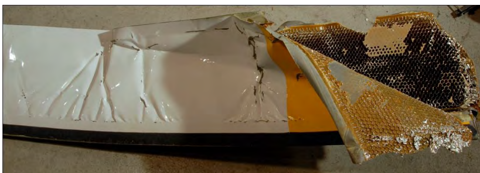
Figur 18: Bruddstedet på hovedrotorblad B med oppflerret hud og rynker forårsaket av bøyning (bladet sett fra oversiden). Foto: SHT
