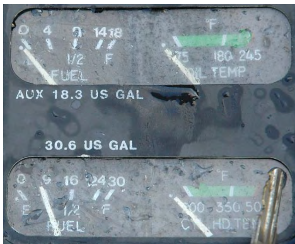
Figur 14: Drivstoffmålerne i LN-OCV like etter berging. Foto: SHT
