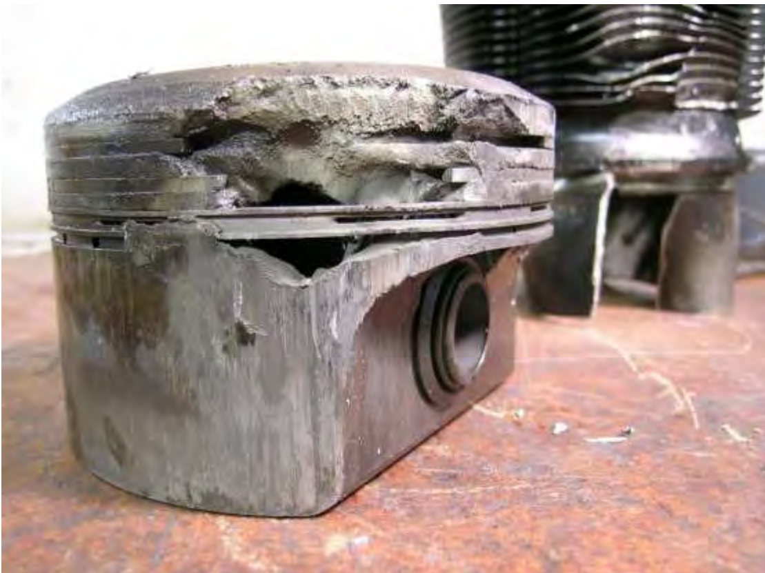
Figur 2. Skader på det bakre stempelet og den ødelagte sylindere i bakgrunnen. Foto: SHT
