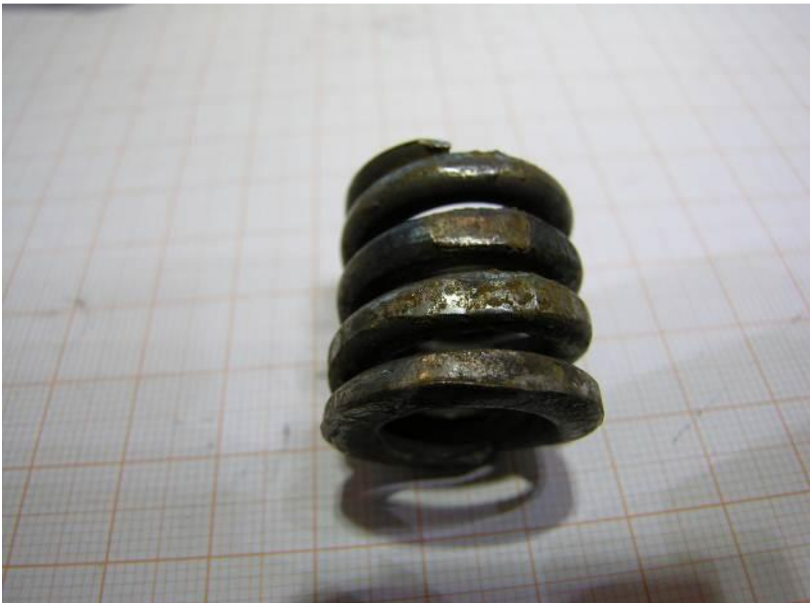
Figur 12: Slitasjespor på en av fjærene etter gnissing mot bruddflatene i indre delen av Clutch Hub (navet). Foto: SHT
