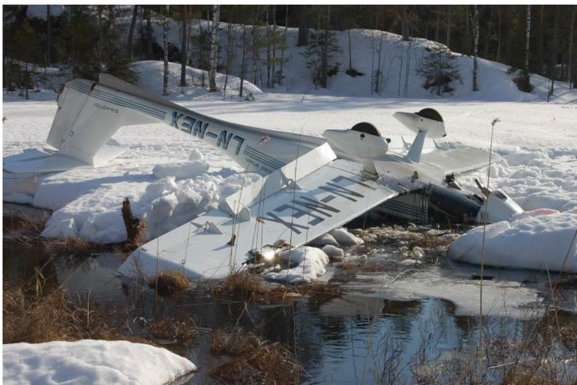
Figur 1: LN-NEX ble liggende opp ned etter nødlandingen. På bildet vises oljesøl på skroget bak motorcowlingen og på undersiden av venstre ving (foran understellsleggen). Foto: SHT
