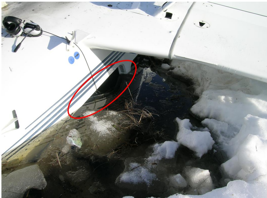
Figur 3: Åpningen som fartøysjef og elev evakuerte gjennom. Foto: SHT
