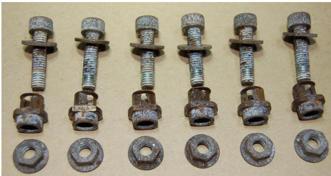
Figur 10: Boltene som holder clutch-hjulene sammen. Slag fra Clutch Hub har slitt hull gjennom alle hylsene. Foto: SHT
