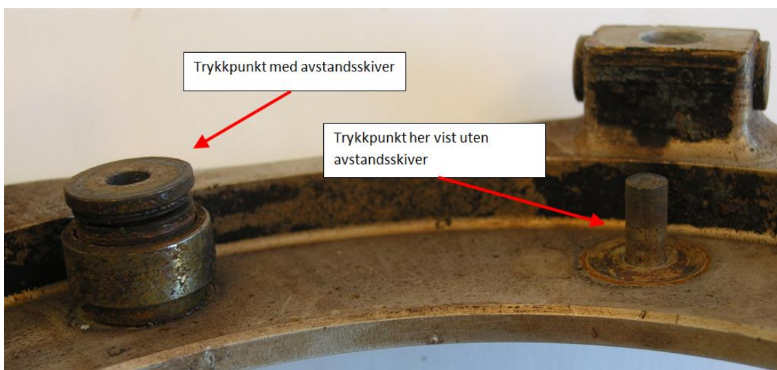
Figur 15: Trykkjusteringspunkt med avstandsskiver. Foto: SHT
