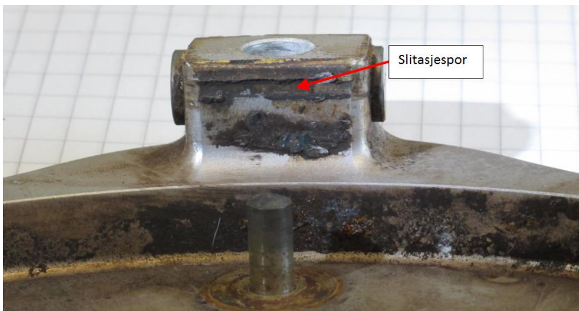
Figur 14: Festelabb med slitasjespor fra lamellplaten. Foto: SHT
