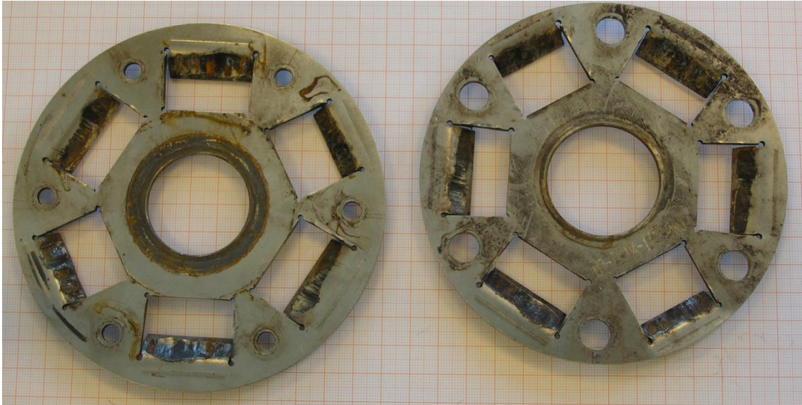
Figur 11: Tilliggende clutch-hjul med slitasjegroper etter fjærene. Legg merke til at det er ulike dimensjoner (både bredde og lengde) på utsparingene i hjulene. Dette er tilpasninger til de ulike fjærtypene. Foto: SHT
