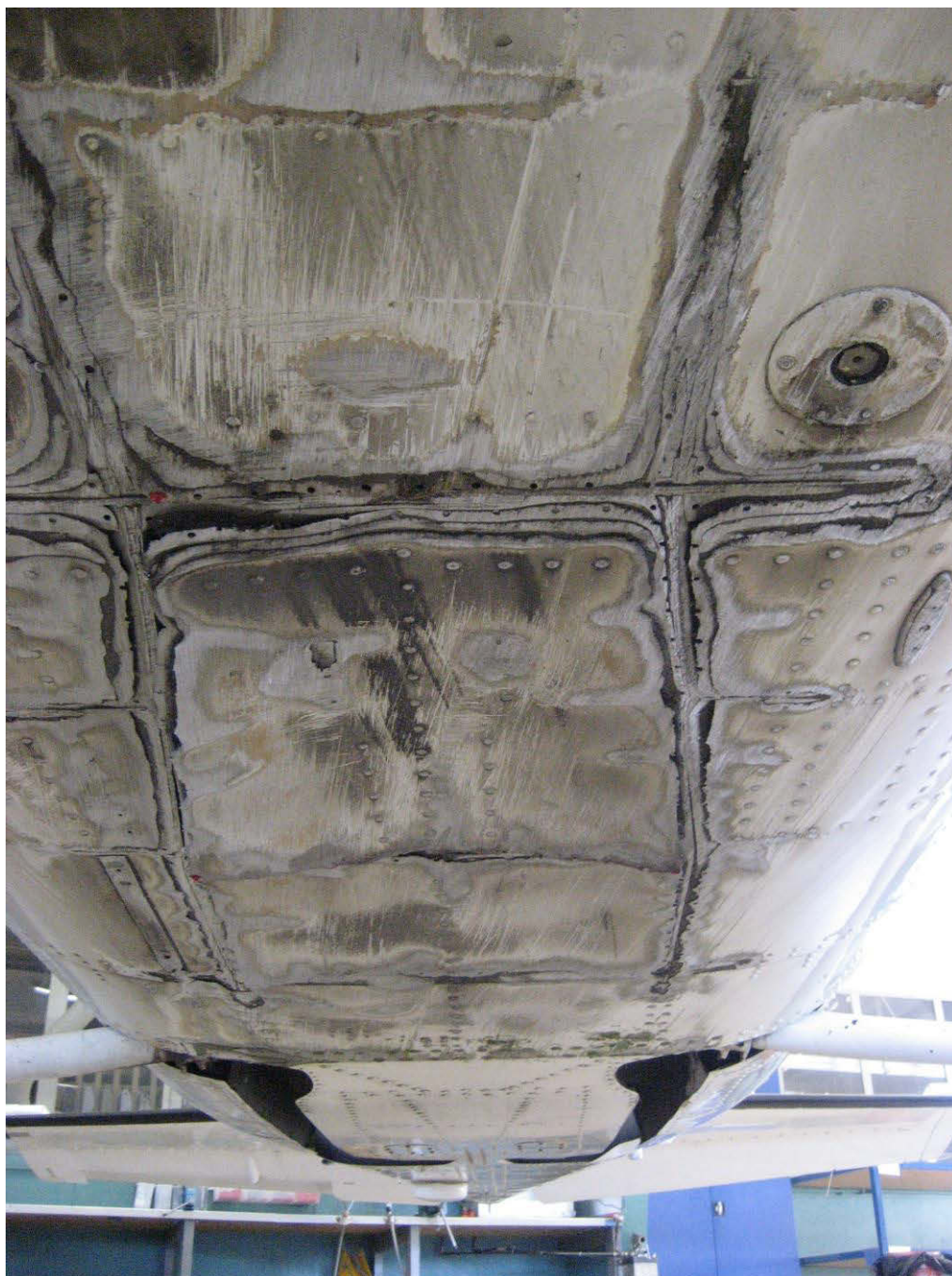
Figur 1: Skader på undersiden av flyet (sett bakover mot halen). Foto: Norrønafly Rakkestad AS
