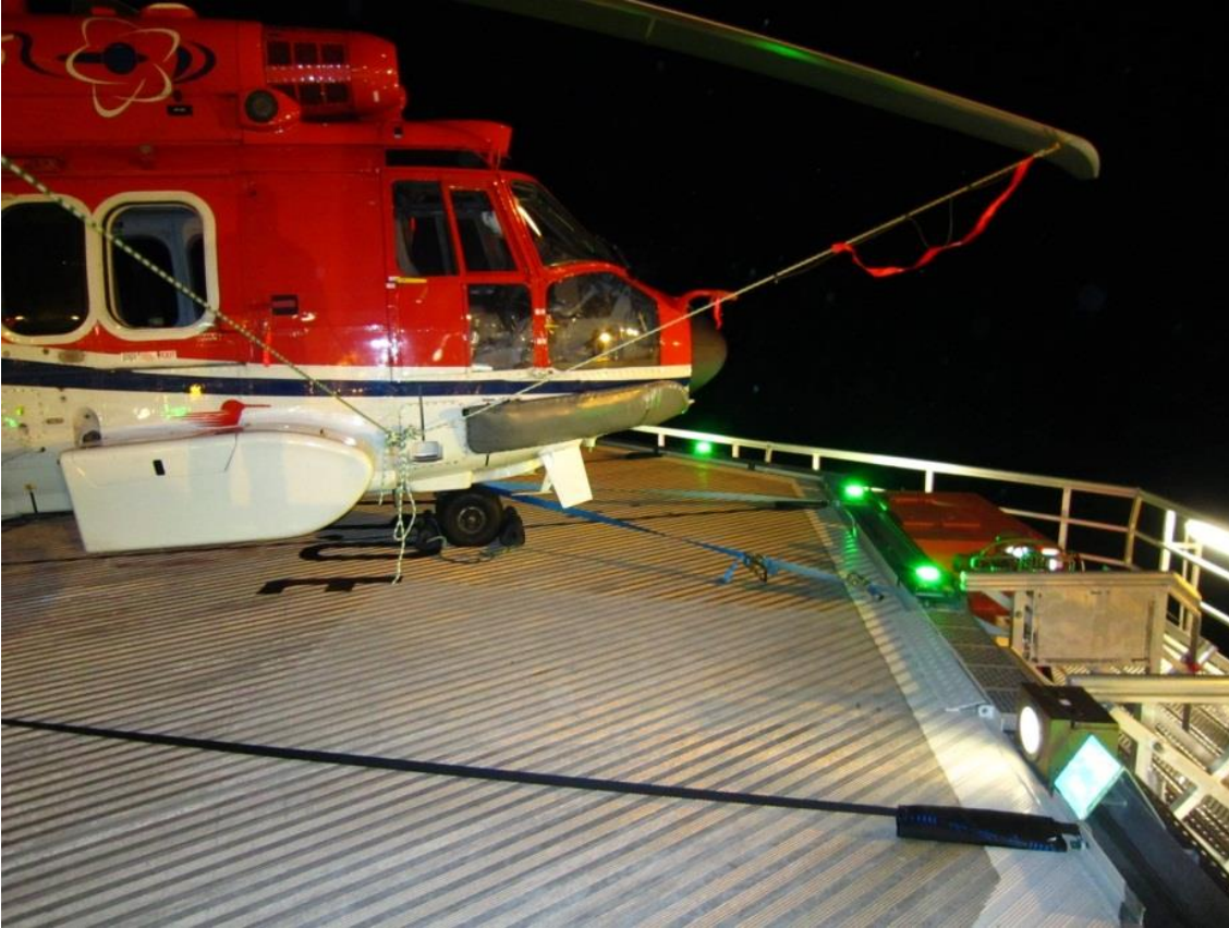
Figur 3: LN-OJE der det stoppet på helikopterdekket på Åsgard B etter landingen. Bildet viser også kanten av helikopterdekket, renna og gangveien som erstatter sikkerhetsnett. Foto: STATOIL
