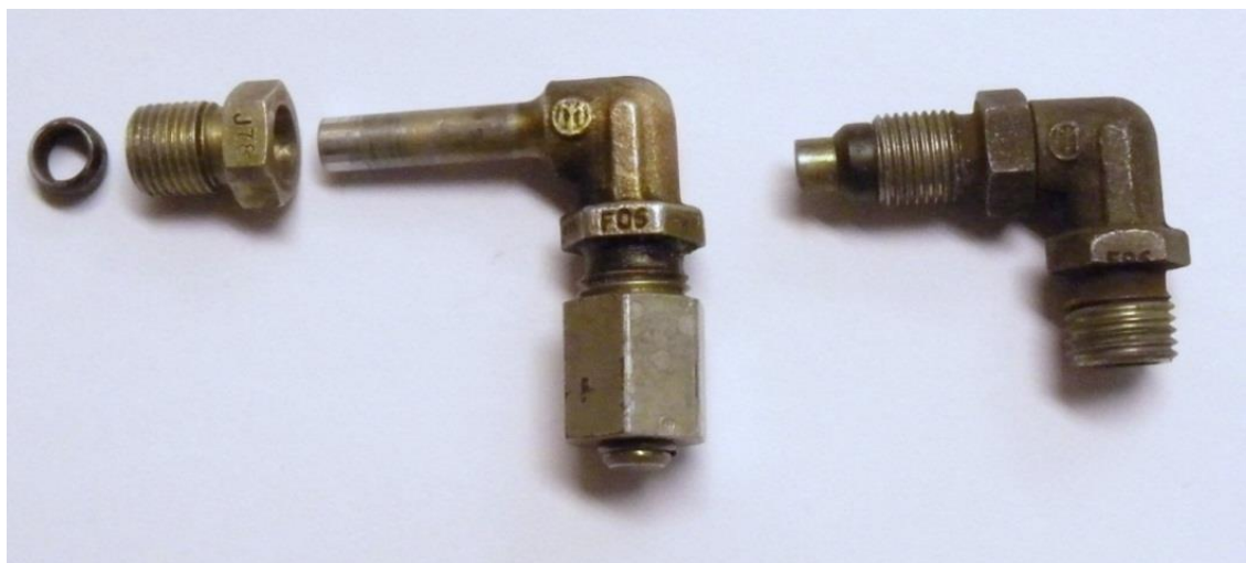
Figur 5: Albuekoblingen fra LN-OJE til venstre. En albuekobling med riktig montert klemring til høyre. Klemringen (mørk) som løsnet ligger til venstre. Foto: SHT
