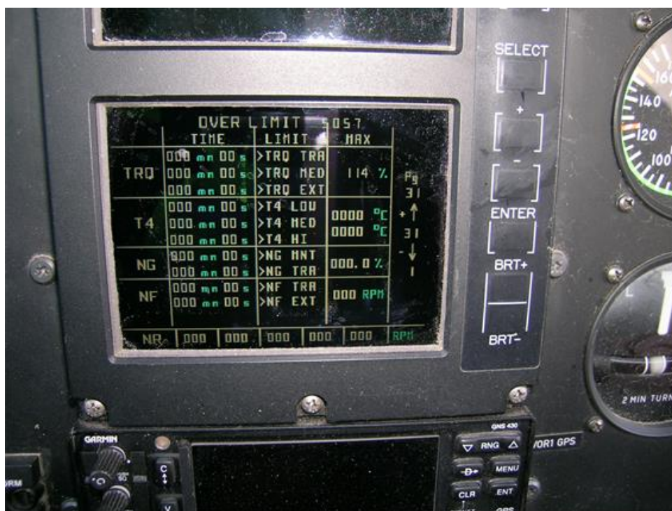
Figur 5: VEMD viser at kraftuttaket (TRQ) hadde vært oppe i 114%. Tidsangivelsen på 00 s indikerer at varigheten på overskridelsen var mindre enn ett sekund. Foto: SHT
