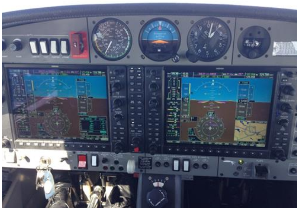
Figur 4: LN-FTL cockpit med Garmin G1000 Integrated flight deck system. Bildet tilhørende Traffic Advisory System (TAS) befinner seg her nederst i høyre hjørne på høyre skjerm (MFD). Se nærbilde i figur 5. Foto: Fartøysjef LN-FTL
