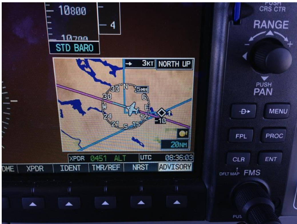
Figur 5: Utsnitt av figur 4 som viser trafikkbildet (TAS). Flyet befant seg ikke i en konfliktsituasjon da dette bildet ble tatt. Bildet viser eget fly i midten, samt et annet fly som klatrer 1 000 ft lavere. Hadde det vært konflikt ville den andre trafikken ha vært representert med en gul, fylt sirkel. Foto: Fartøysjef LN-FTL
