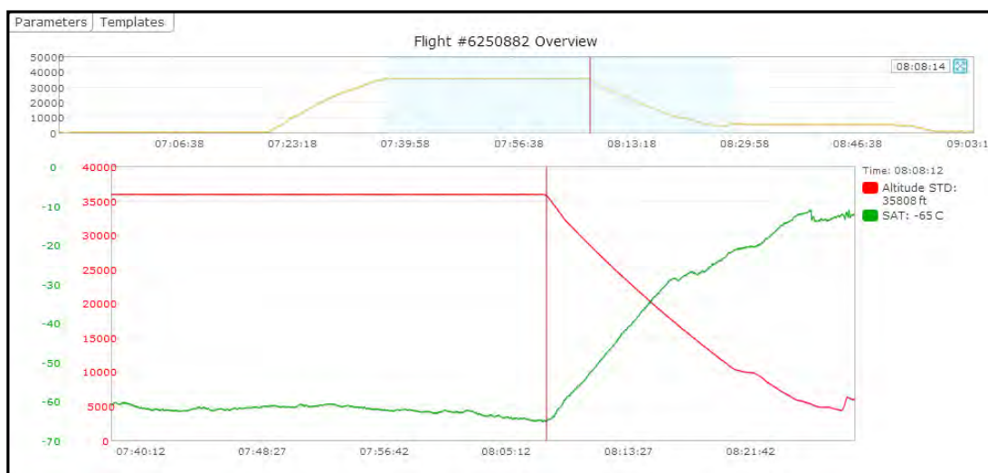
Figur 9: Viser utvendig temperatur (SAT) fra flyet var etablert på marsjhøyde og frem til like etter hendelsen i Kittilä. Kilde: SHT (data hentet fra flyets ferdskriver)
