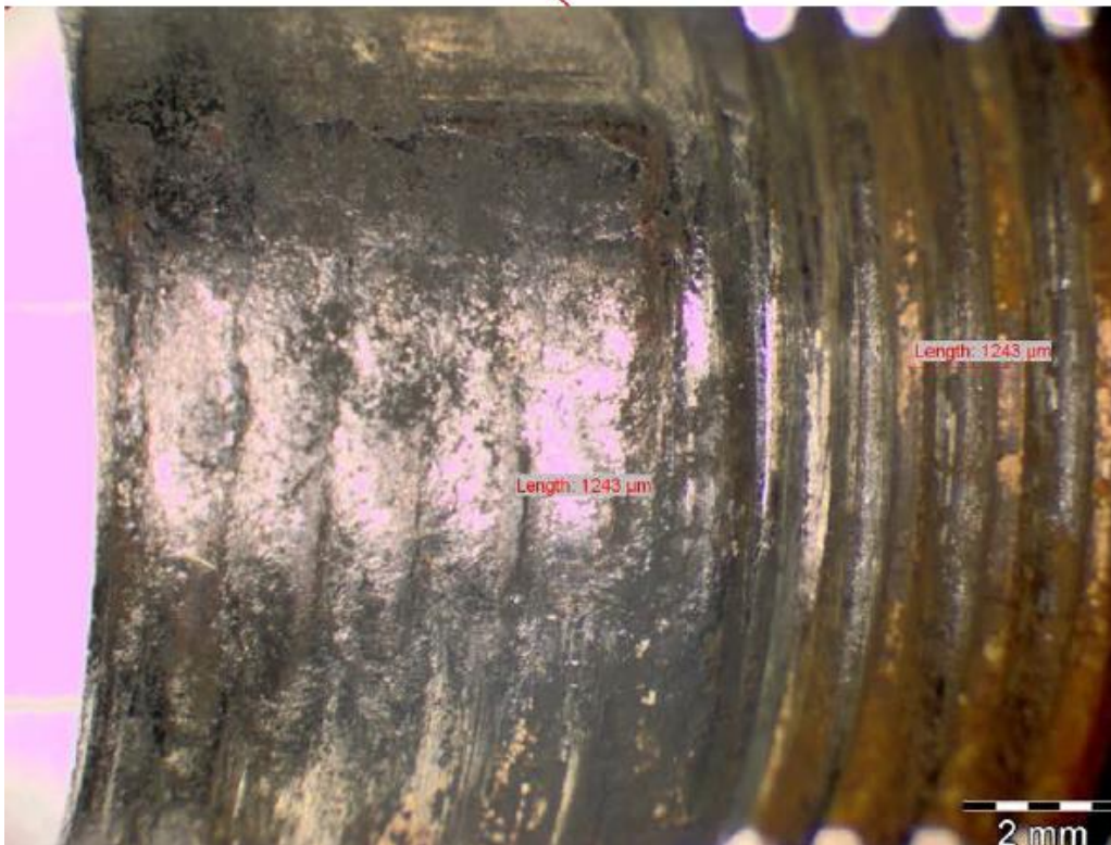
Figur 6: Spor etter boltgjenger i foring. Foto: FLO Materiallab
